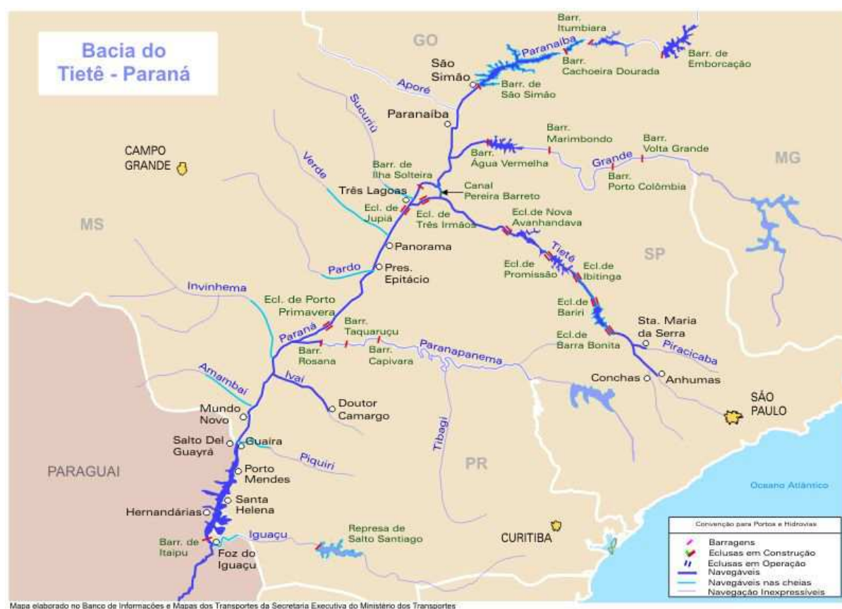
FIGURA 19-I - BACIA PARANÁ-TIETÊ, COM PRINCIPAIS BARRAGENS, RESERVATÓRIOS E ECLUSAS DA HIDROVIA PARANÁ-TIETÊ.
